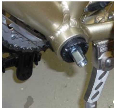
Perinteiseen 4-kantikeskiöön polkuanturinon asennus on helppoa
