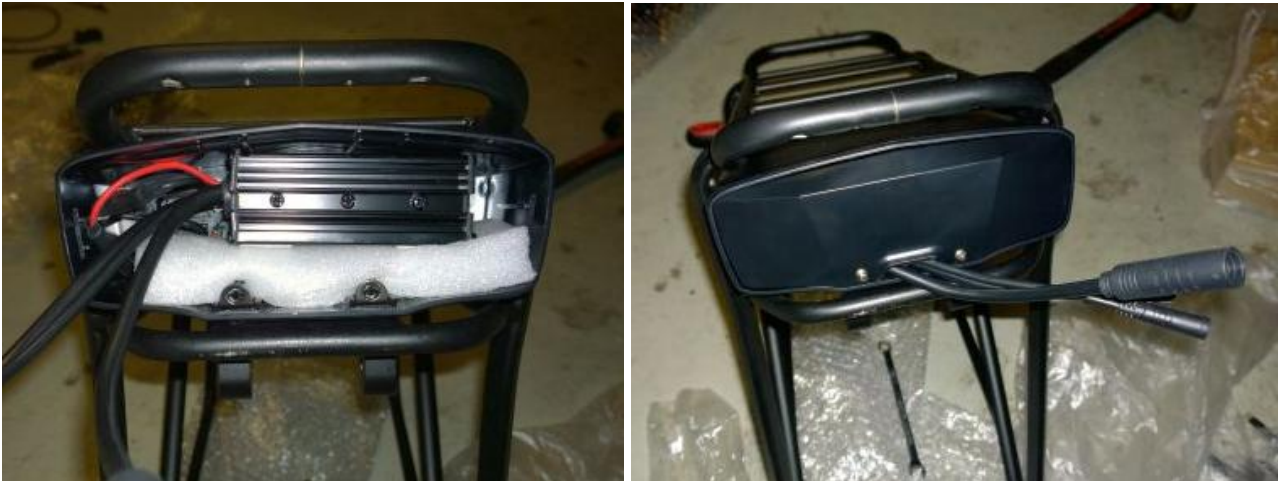
Kuvissa 250w sarjan ohjausyksikkö asennettuna Samsung tarakka-akun virtaterminaalin sisään.
